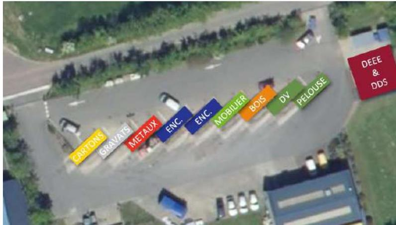
Figure 2 : Vue aérienne de la déchetterie communautaire de La Haye. Y sont visibles les 9 quais où sont positionnées 9 bennes de 20 à 30m<sup>3</sup>, le local ouvert pour DEEE et DDS (toit gris à droite), le local fermé pour DDS (toit blanc à droite), le bureau du gardien de déchetterie (toit bleuté en haut à droite) et la benne d'amiante de 15m<sup>3</sup> (en bas à droite).
